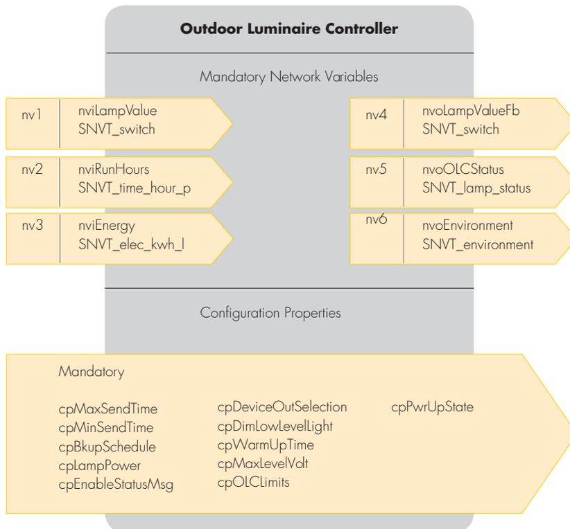
Gemäß der erwähnten Ansi bzw. EN-Spezifikation verfügt der Controller über eine interoperable Netzwerkschnittstelle, die die Voraussetzung bietet, heterogen Netzwerke aufzubauen. Die Definition der exakten Datenstruktur für den Datenaustausch ist gemäß der Lonmark-Definition nach dem sogenannten OLC-Profil (Outdoor- Luminaire-Controller) festgeschrieben. Firmen die einen Controller gemäß diesem Standard entwickelt haben, können in ein gemeinsames Netzwerk integriert werden.
