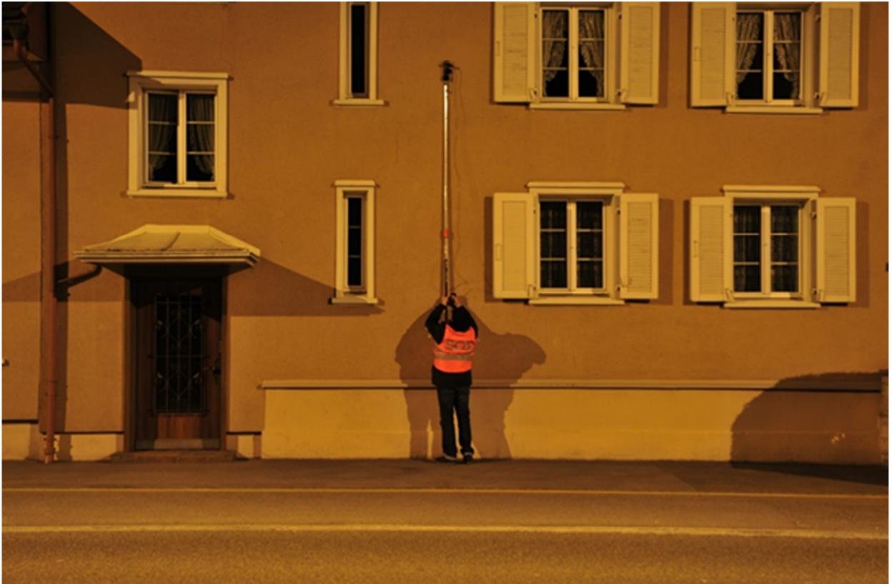
Bild: Messungen der vertikalen Beleuchtungsstärke mittels Teleskopstange
