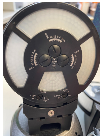
Bild oben: an der Unterseite des Melders sind die einfachen und bewährten Einstellschrauben.
